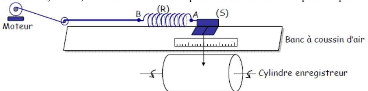
1. En faisant tourner le moteur à la fréquence **N<sub>e</sub>= 1Hz (=1tr.s<sup>-1</sup>)**, le solide (S) se met à osciller sur le bac de part et d'autre de sa position d'équilibre. Une fois le régime permanent est établi on réalise l'enregistrement ci-après.
